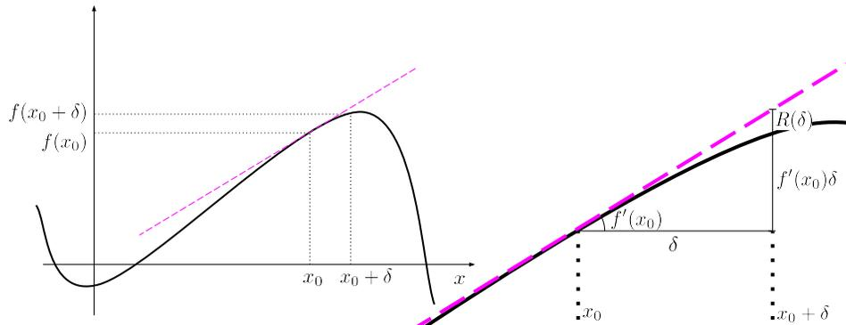
Figure 1: Linearizzazione di una funzione: se la funzione stessa viene sostituita dalla retta tangente in un punto  $x_0$ , la differenza tra il valore della funzione e il valore della approssimazione lineare per gli  $x$  vicini a  $x_0$  e' piccola. Nell'ingrandimento (a destra) si nota che se si immagina di scegliere un  $\delta$  piu' piccolo il rapporto tra  $R(\delta)$  e  $\delta$  diventa sempre piu' piccolo.
