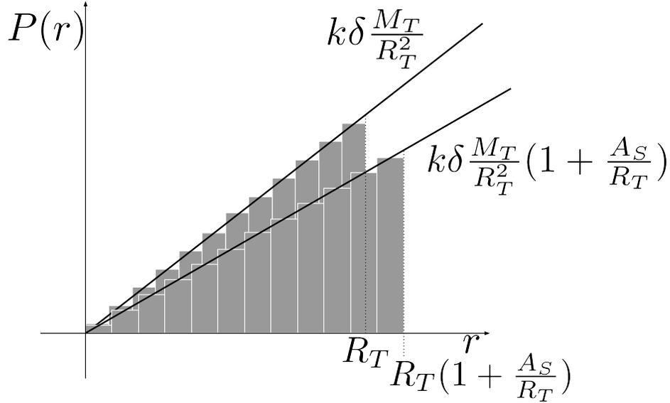
Figure 5: Il calcolo dell'escursione mareale consiste nel trovare la base di un secondo triangolo limitato da una retta con coefficiente angolare piu' piccolo, in modo tale che l'area dei due triangoli sia la stessa
