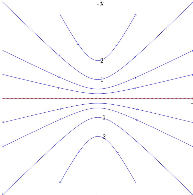
e dunque sono tutti i punti della forma  $(x, 0)$ ,  $x \in \mathbb{R}$  (cioè i punti dell'asse  $x$ ). Per studiarne la stabilità, calcoliamo lo jacobiano della funzione vettoriale definita dai secondi membri delle equazioni del sistema,  $f(x, y) = (y, \frac{xy^2}{1+x^2})$ . Si ottiene
