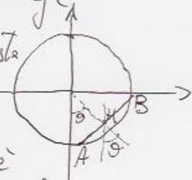
Dalla figura è evidente che  $\vartheta$  è anche l'angolo che descrive la rotazione dell'asta rispetto a un asse di riferimento (ad es. quella verticale discendente). Di conseguenza,  $T_{S;AB} = \frac{1}{2} I \dot{\vartheta}^2$  dove  $I$  è il momento
