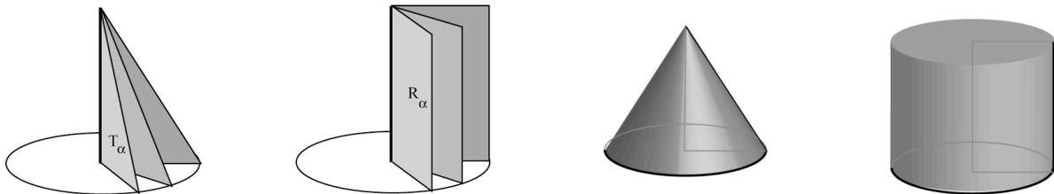
Dato che il cilindro è fatto dalla stessa infinità di parti del cono e dato che ogni parte  $R_\alpha$  ha estensione doppia della corrispondente parte  $T_\alpha$ , ci si aspetterebbe che l'estensione del cilindro, cioè il suo volume sia il doppio di quello del cono. Risulta invece che il volume del cilindro è tre volte quello del cono!
