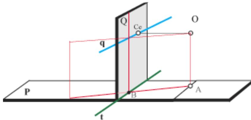
Le rette verticali del piano per  $B, C, D \dots$  del piano  $Q$  sono l'immagine delle rette  $AB, AC, AD, \dots$  del piano  $P$
