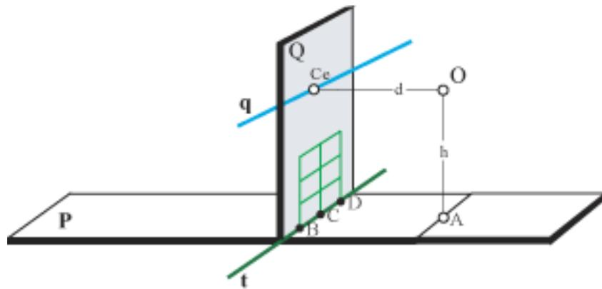
Osserviamo intanto, prima attraverso l'osservazione del prospettografo, che una qualunque retta del piano  $P$  che passa per il punto  $A$ , si proietta in una retta parallela a  $OA$  cioè, se  $A$  è la proiezione ortogonale di  $O$  su  $P$ , in una retta verticale.
