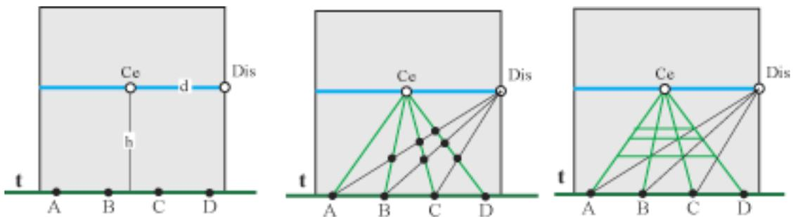
Le linee di profondità per  $A, B, C, D$  sono parallele e si proiettano in linee che convergono a  $C_e$ . Le diagonali passanti per  $A, B, C$  inclinate a  $45^\circ$  rispetto alla linea di terra sono parallele e si proiettano in rette convergenti in  $Dis$ . I punti in cui si incontrano le diagonali con le linee di profondità danno la posizione delle linee parallele alla linea di terra che si proiettano in linee parallele alla linea di terra.
