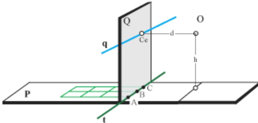
Cominciamo a disegnare sul piano  $Q$  del quadro i punti  $A, B, C, D, \dots$  sulla “retta di terra”  $t$ , il punto  $C_e$  ad una altezza  $h$  dalla retta  $t$  e da quel punto tracciamo la parallela  $q$  alla linea di terra (la linea dell’”orizzonte”) sulla quale si proiettano i punti all’infinito del piano  $P$ . Disegniamo poi, a una distanza  $d$  da  $C_e$ , sulla linea dell’orizzonte, il punto  $Dis$ .
