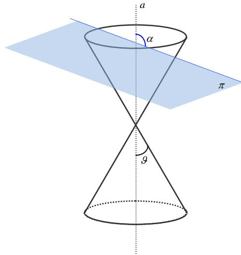
diremo che esistono due sfere iscritte in una superficie conica e tangenti ad un piano  $\pi$  (che la interseca e non passa per il vertice) se l'angolo  $\theta$  non è uguale all'angolo  $\alpha$  formato dall'asse della superficie col piano  $\pi$ ; ne esiste una sola se  $\theta = \alpha$ .
