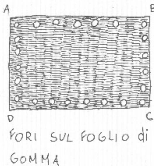
Si fa anche un piccolo foro al centro (H) senza rinforzarlo con le rondelle. Si fissano con delle viti i fori A, B, C e D alla base in modo che il foglio di gomma sia poco tirato.
