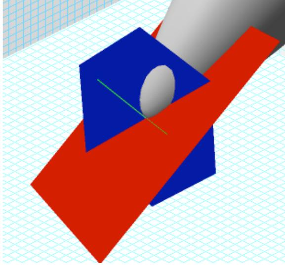
Una sezione non normale del paraboloido  $\mathbf{S}(u, v) = \begin{pmatrix} u \\ v \\ u^2 + v^2 \end{pmatrix}$  in  $P = \begin{pmatrix} 0 \\ 0 \\ 0 \end{pmatrix}$ .
