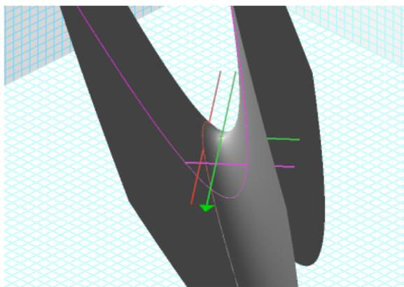
L'iperboloido  $\mathbf{S}(u, v) = \begin{pmatrix} u \\ v \\ u^2 - v^2 \end{pmatrix}$  e le linee coordinate  $\begin{pmatrix} u \\ 1 \\ u^2 - 1 \end{pmatrix}$  e  $\begin{pmatrix} 2 \\ v \\ 4 - v^2 \end{pmatrix}$ , per il punto  $\mathbf{S}(2, 1)$ .
