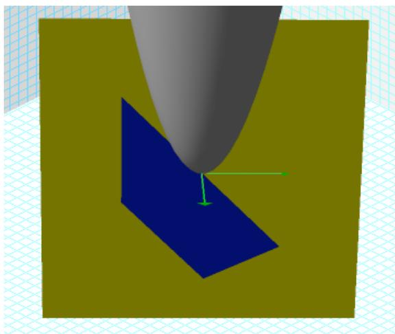
Una sezione normale del paraboloide  $\mathbf{S}(u, v) = \begin{pmatrix} u \\ v \\ u^2 + v^2 \end{pmatrix}$  in  $P = \begin{pmatrix} 0 \\ 0 \\ 0 \end{pmatrix}$ .
