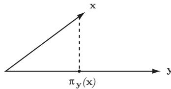
Fig.5. La proiezione ortogonale del vettore  $\mathbf{x}$  sul vettore  $\mathbf{y}$ .
